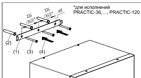
Рисунок 4. Установка прибора на вертикальное основание
